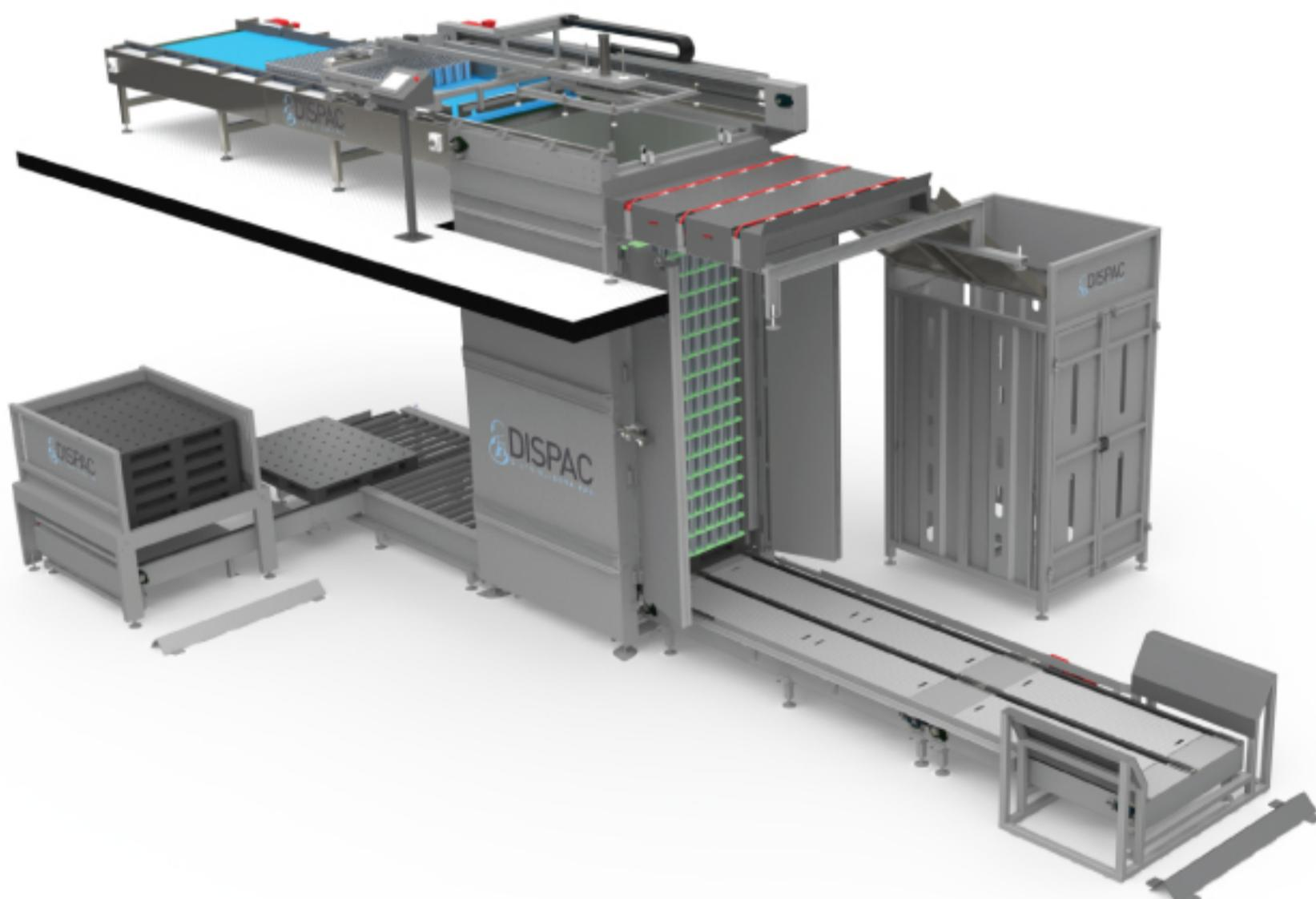
Depaletizadores DISPAC. Son máquinas industriales modulares que combinan componentes mecánicos, eléctricos y neumáticos. Está considerada para el inicio de la línea de producción. Su función principal es desmontar pallets de mercancías o productos con ciclos de funcionamiento automático para conseguir uniformidad y facilidad de manipulación; así se ahorra espacio y se rentabiliza el tiempo de descarga. Es capaz de depaletizar una gran variedad de tamaños de lata.
